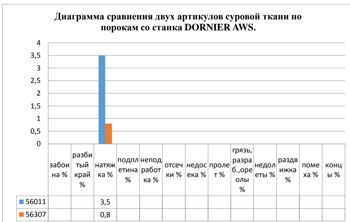
Рисунок 4.2. Диаграмма пороков суровых тканей, выработанных на ткацком станке DORNIER AWS.
